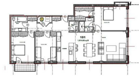
PLAN D'UNITE 101 SCALE 1/8" = 1'-0"
